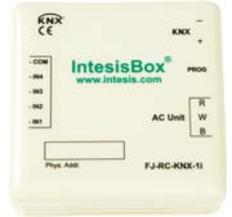
Die KNX-Schnittstelle FJ-RC-KNX 1i ermöglicht die vollständige Integration der Fujitsu Klima-Inneneinheiten in ein KNX basierendes Netzwerk. Mit dieser Schnittstelle lassen sich alle bekannten, grundlegenden Funktionen wie Start/Stop, Temperatur-, Lüfter-, Luftleitlammellensteuerung, Betriebsartenwahl und verschiedene Timerfunktionen bedienen.
