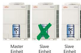
Abb.: Notfallbetrieb Außeneinheiten
