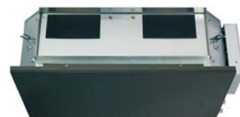
Die Zwischendeckenmodelle ARXC 36-90GATH mit einer statischen Pressung von 100-300 Pa werden vor allem dort eingesetzt, wo höchste Leistungsfähigkeit in punkto Luftmenge und Kühlleistung gefordert ist. Aufgrund der hohen statischen Pressung können auch sehr lange Luftleitungen angeschlossen werden.
