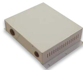
Der Signalverstärker UTY-VSGXZ1 ermöglicht die Erweiterung des ersten Netzwerksegments innerhalb des VRF-Systems um ein weiteres. Das neu hinzugekommene Netzwerksegment kann wiederum weitere 63 Einheiten und zusätzliche 500 Meter Bus-Leitung beinhalten. Mit bis zu 8 Signalverstärkern kann das Bus-Netz des VRF-Systems auf insgesamt 3.600 Meter ausgeweitet werden.
