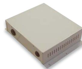
Die LonWorks-Schnittstelle UTY-VLGX erlaubt den Anschluss von VRF-Netzwerken mit bis zu 128 Einheiten an eine LonWorks-kompatible Gebäudeleittechnik (GLT). Die Schnittstelle entschlüsselt VRF LON-Signale in ein offenes LonWorks-Protokoll.
