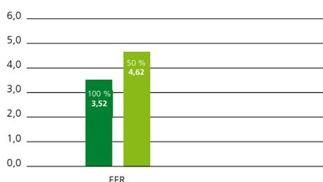
Gerade in modernen, gut isolierten Gebäuden ist der Heizbedarf im Winter und in der Übergangszeit deutlich geringer als der Kühlbedarf im Sommer. VRF-Systeme werden in der Regel für den Kühlbedarf im Sommer mit 100 W/m<sup>2</sup> ausgelegt. Zum Heizen im Winter werden jedoch lediglich 50 W/m<sup>2</sup> benötigt. Aus diesem Grund stellt ein VRF-System auch im Winter immer ausreichend Heizleistung zur Verfügung, selbst bei besonders niedrigen Außentemperaturen.
