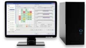
Beim modular aufgebauten System-Controller Lite lassen sich die benötigten Funktionen individuell zusammenstellen. Mit der Basissoftware lassen sich bis zu 400 Inneneinheiten steuern und überwachen. Die Funktionspakete Einzelkostenabrechnung, Energiesparmanagement und Fernzugriff erhöhen die Anwendungsvielfalt noch weiter.
