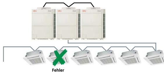
Abb.: Notfallbetrieb Inneneinheiten
