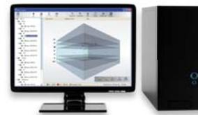
Der System-Controller UTY-APGX ist eine zentrale, PC-gesteuerte Überwachungseinheit zum präzisen Klimatisieren und zentralen Steuern aller angeschlossenen Klimageräte. Das Programm kann **sowohl als Server- als auch als Clientsoftware** auf einen PC aufgespielt werden. Über die Serversoftware sind bis zu vier lokale VRF-Netzwerke und durch die Clientsoftware bis zu 10 PCs mit Serversoftware über das Internet auswählbar.
