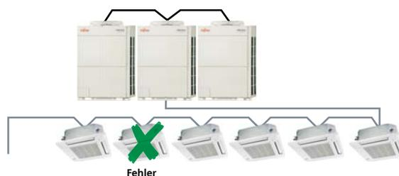
Abb.: Notfallbetrieb Inneneinheiten
