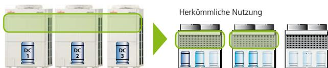
Beispiel: Die Leistung wird auf alle Außeneinheiten verteilt (V-II Verbund)
