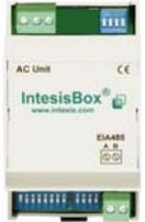
Die Modbus-Schnittstelle FJ-RC-MBS 1 ermöglicht die vollständige Integration der Fujitsu Klima-Inneneinheiten in ein Modbus basierendes Netzwerk. Mit dieser Schnittstelle lassen sich alle bekannten, grundlegenden Funktionen wie Start/ Stopp, Temperatur-, Lüfter-, Luftleitlammellensteuerung, Betriebsartenwahl und verschiedene Timerfunktionen bedienen.
