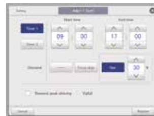
Bildschirmanzeige für Leistungsbegrenzung (Lastabwurf) des Außengeräts.
